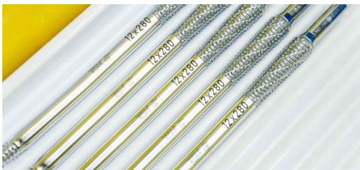
Avec les lasers à impulsions ultracourtes du TruMicro Mark, l'entreprise appose des marquages robustes et durables.
