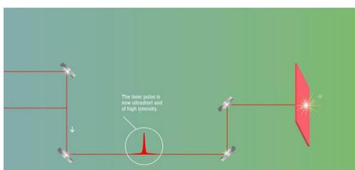
Leurs impulsions ultracourtes permettent un usinage de matières précises et
