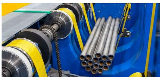
Après la coupe des tubes sur la TruLaser Tube 7000, les tubes sont transportés jusqu'au réseau d'installations où le robot les place dans une auge à paquet puis les sépare sur une table.
