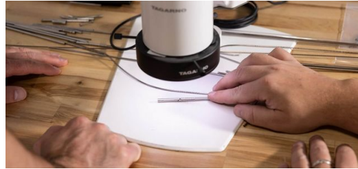
L'équipe d'Alpine Laser lors de l'inspection d'un stent.
