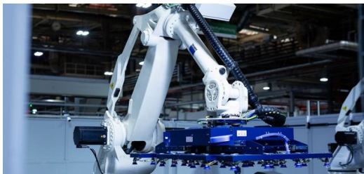
Les deux robots de déchargement ont beaucoup à faire : les composants affluent de la chambre de découpe laser.
