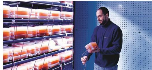
Contrôle qualité : un spécialiste en technique de réfrigération vérifie le pouvoir réfrigérant d'une vitrine à l'aide de sondes de température pour simulateurs d'aliments.
