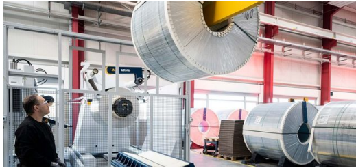
<p>L'opérateur machine Martin Müller hisse une bobine de feuillard d'aluminium de 16 tonnes dans la zone de chargement de la TruLaser 8000 Coil Edition de TRUMPF.</p>
