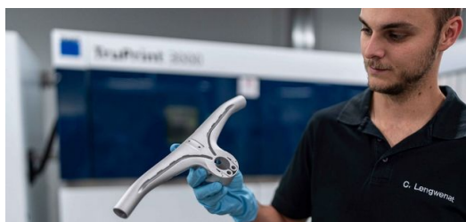
Le guidon se base principalement sur une unité avec des canaux semi-internes pour les câbles de frein.
