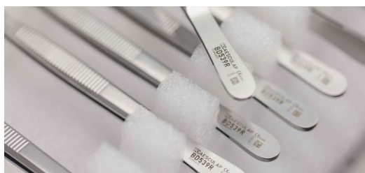
L'équipe de Suzhou appose chaque année des marquages précis sur plus d'un million d'instruments chirurgicaux, partiellement en petites séries.
