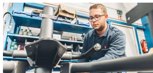
La tringlerie d'un appareil de fitness EGYM se compose principalement de tubes d'acier ovales. Après l'usinage avec une machine de découpe de tubes au laser TRUMPF, elle reçoit une finition élégante gris foncé via une application de poudre.
