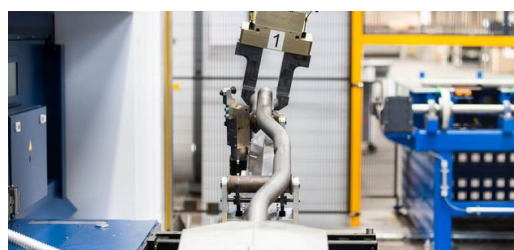
Les installations du réseau de machines sont commandées de manière automatisée par un système robotique qui transporte les pièces d'une étape d'usinage à la suivante.
