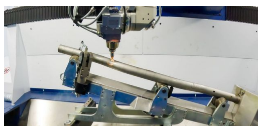
Avec l'installation laser 3D TruLaser Cell 8030 de TRUMPF, il est possible de découper des contours précis qui ne peuvent pas être introduits avant le pliage, car ils se déformeraient.
