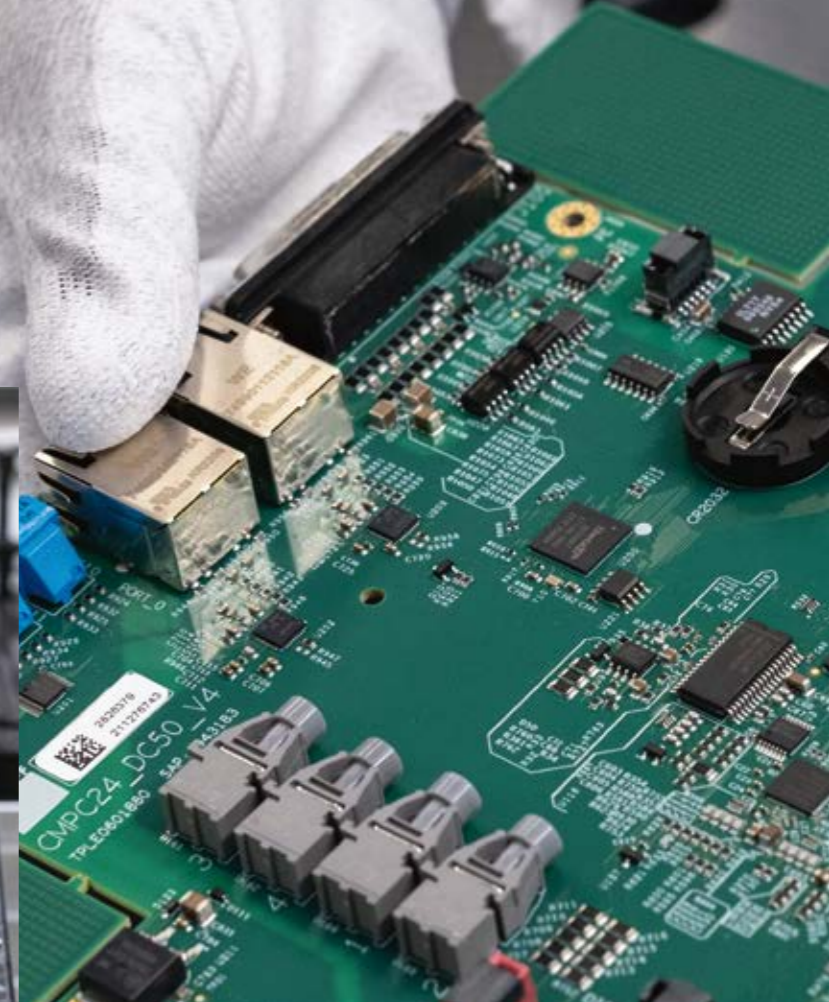
Das Herzstück des Plasmagenerators ist die Leiterplatte. Als Schaltzentrale steuert sie alle Funktionen. TRUMPF designt und fertigt die Leiterplatten an den Standorten rund um Warschau.
