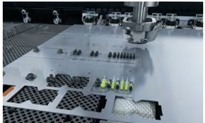
Listones de ventosas con vasos de succión activados de forma individual.
