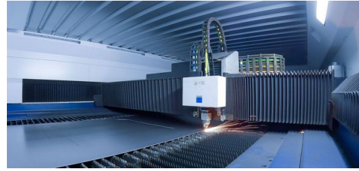
<p class="MAGAFIetext">El cabezal láser se desliza sobre la aparentemente interminable banda de chapa y corta los contornos de las partes exteriores de la superficie exterior de los tractores Fendt.</p>
