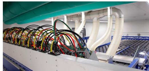
Laserlichtleitungen verbinden die Optiken mit den Lasern. Bild: Ralf Kreuels
