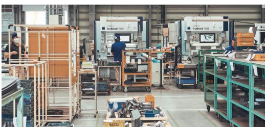
La planificación del layout de la nueva nave de producción y la disposición de las máquinas TRUMPF redujeron el tiempo de producción un 40 %.
