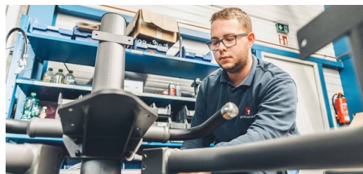
Las barras de una máquina deportiva EGYM están compuestas sobre todo por tubos de acero ovalados. Tras el mecanizado en una máquina de corte de tubos por láser TRUMPF recibe un recubrimiento de polvo en un elegante acabado gris oscuro.
