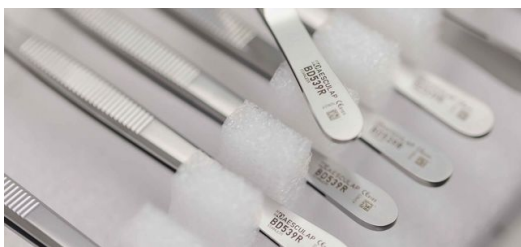
El equipo de Suzhou aplica marcados precisos a más de un millón de instrumentos quirúrgicos al año, algunos de los cuales se fabrican en pequeñas series.
