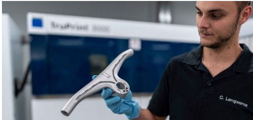
El manillar consiste básicamente en una unidad con conductos semiinternos para los cables de freno.
