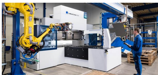
La nueva máquina de plegado basculante TruBend Center 7020 ha sido fundamental en la producción de la estufa de campaña. Solo gracias a esta instalación, el equipo de Kuipers ha logrado plegar el relativamente grande espacio de combustión de 333 milímetros.
