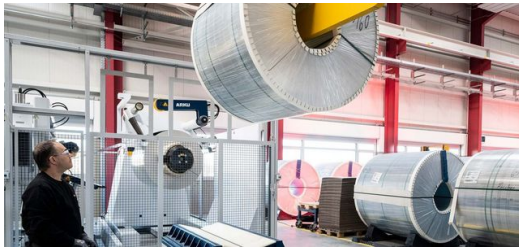
El operario de máquinas Martin Müller eleva un rollo de aluminio de 16 toneladas en la zona de carga de la TruLaser 8000 Coil Edition de TRUMPF.
