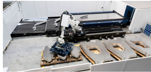
Laser Blanking: un robot clasifica de forma automática los componentes cortados.
