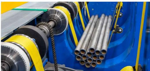
Una vez que los tubos se han cortado a medida en la TruLaser Tube 7000, se transportan al conjunto de instalaciones, donde el robot los coloca en un soporte de agrupación de tubos y, a continuación, los separa en una mesa.
