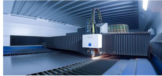
El cabezal láser se desliza sobre la aparentemente interminable banda de chapa y corta los contornos de las partes exteriores de la superficie exterior de los tractores Fendt.
