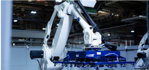
Los dos robots de descarga tienen mucho trabajo por delante: los componentes salen en tropel de la cámara de corte por láser.
