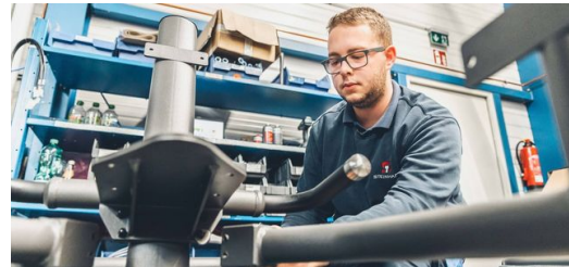
<p>Las barras de una máquina deportiva EGYM están compuestas sobre todo por tubos de acero ovalados. Tras el mecanizado en una máquina de corte de tubos por láser TRUMPF recibe un recubrimiento de polvo en un elegante acabado gris oscuro.</p>
