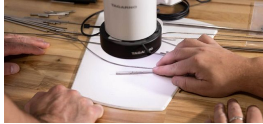
El equipo de Alpine Laser inspecciona un stent.
