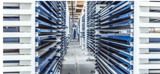
El almacén STOPA completamente automatizado con 400 puestos es para Tim Ungerer uno de los hitos de las numerosas medidas de automatización.
