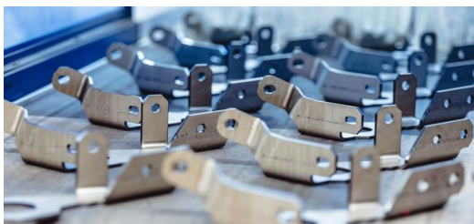
En el mecanizado de chapa propio, MERZ procesa diariamente, en funcionamiento de tres turnos, entre diez y quince toneladas de chapa fina. Una elevada variación de piezas con cantidades comprendidas entre una y
