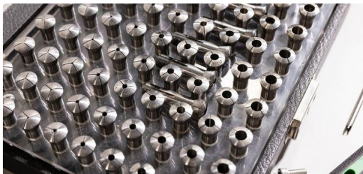
<p>Gracias a útiles altamente flexibles, la preparación del portapiezas y la alineación de las ópticas dura menos de cinco minutos. Aquí podemos ver los útiles para el portapiezas.</p>
