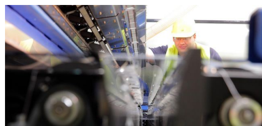
Strahlfallen befinden sich oberhalb und unterhalb der Laserlinie. Bild: Ralf Kreuels
