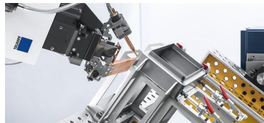
<p>Das neue Verfahren FusionLine verbindet Teile auch dann, wenn Spalte überbrückt werden müssen. Es gleicht Ungenauigkeiten beim Schweißvorgang aus und schließt Spalte mit bis zu einem Millimeter Breite. Viele Bauteile, die für konventionelle<br />Schweißverfahren konstruiert wurden, lassen sich so mit dem Laser bearbeiten. (Foto: Oliver Graf Fotostudio GmbH)</p></p></p>
