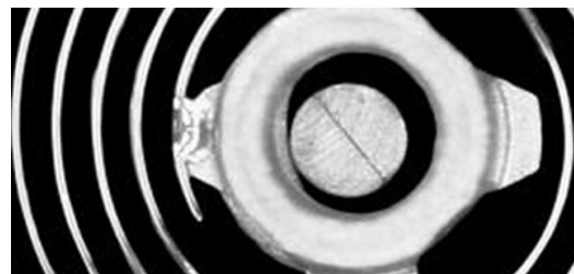
Der Schweißpunkt hat einen Durchmesser von 0,2 Millimetern
