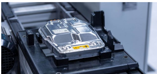
Laser 1: Aluminium gasdicht schweißen. Webasto nutzt einen Scheibenlaser, der auch unter atmosphärischem Druck ohne Schutzgas arbeitet – möglichst schnell, leistungsstark und mit einer porenfreien Schweißnaht.
