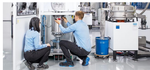
Der Bauzylinder wird in der Entpackstation befestigt. © Claus
