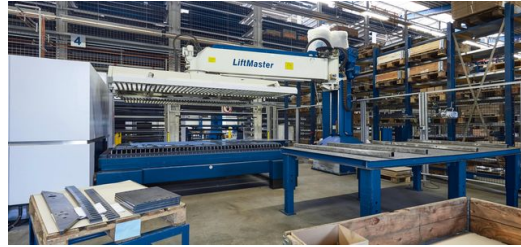
Ein Stopa-Hochregallager sorgt bei Schickling für Materialnachschub, ein LiftMaster für leichteres Teilehandling. (Foto: Claus Langer)
