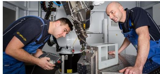
Daniel Voß, Schweißer bei CBV und Konstruktionsmechaniker Marcus Hüttenrauch, finden nach einer Schulung bei TRUMPF eigene Wege, um das Beste aus der TruLaser Robot herauszuholen. So sparen sie sich beispielsweise Vorrichtungszeit und -kosten, indem sie mit dem Roboter die Bauteile manuell einfahren. (Bild: Bernd Liebl)
