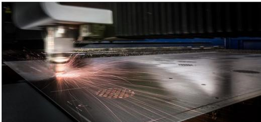
Die TruLaser 5030 fiber schneidet mit einem drei Kilowatt TruDisk Laser flexibel dicke und dünne Bleche in Materialien wie Kupfer und Messing sowie Baustahl, Edelstahl und Aluminium. „Sie ist extrem schnell und die Nebenzeiten sind auch bei unseren kleinen Serien sehr gering“, sagt Werner Neumann. (Bild: Bernd Liebl)
