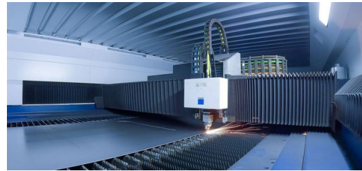
Der Laserkopf saust über das schier endlose Blechband und schneidet die Konturen der Außenhautteile der Fendt Traktoren.
