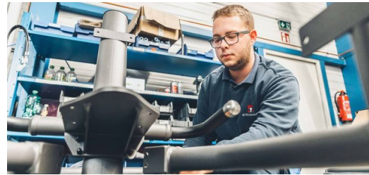
Das Gestänge eines EGYM-Fitnessgeräts besteht aus überwiegend ovalen Stahlrohren. Nach der Bearbeitung auf einer TRUMPF Laser-Rohrschneidemaschine bekommt es durch Pulverbeschichtung ein edles dunkelgraues Finish.
