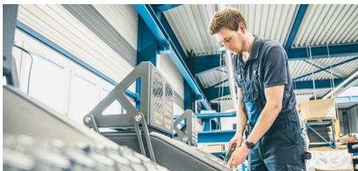
<p>Die Aluminium-Riffelbleche für die EGYM-Geräte schneidet und formt die TruMatic 7000 kratzerfrei und in bester Qualität.</p>
