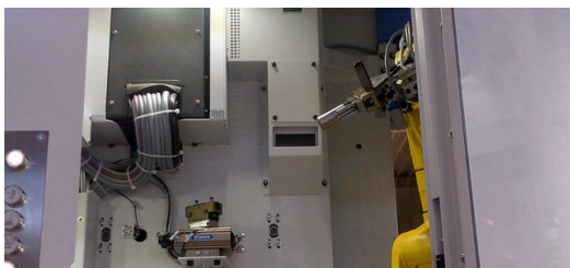
Individuelle Markierung als selbstverständlichen Schritt schon in der Maschine: Nach der Qualitätsprüfung übergibt der der Roboter in der automatisierten Fertigungszelle vom Typ FLEXCELL UNO das Werkstück an die fest integrierte Markierstation. Bild: TRUMPF
