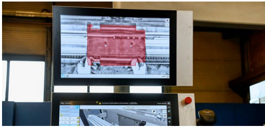
Der Part Indicator im Einsatz: Das System zeigt sofort an, ob das Biegeteil richtig oder falsch eingelegt ist. Rot heißt, hier ist noch ein Fehler.
