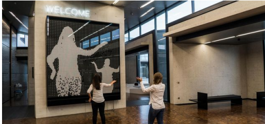
Die Flip-Dot-Wall wandelt mit Hilfe von Elektromagneten individuelle Körperbewegungen in Echtzeit in digitale Sequenzen um.
