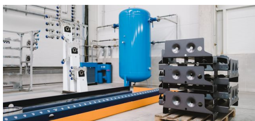
<p>Die Bearbeitung großer und schwerer Teile mit Gewichten zwischen 60 und 80 Kilogramm sind bei PNH an der Tagesordnung. Um seine Mitarbeiter zu schonen hat Martin Mitterhumer seine Anlage mit Vakuum- und Zangengreifern ausgestattet.</p> – Stefan Fuertbauer
