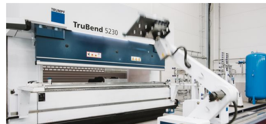
<p>Fachkräfte sind auch in Ungarn Mangelware. Mit automatisierten Systemen wie der TruBend Cell 5000 mit Bendmaster 150 verschafft sich Geschäftsführer Martin Mitterhumer entscheidende Wettbewerbsvorteile.</p> – Stefan Fuertbauer
