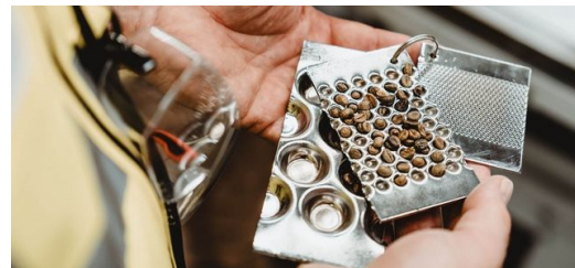
Passgenau: Das Korn muss exakt in die Vertiefungen im Blech, die „Taschen“, passen.
