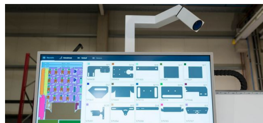
Der große Bildschirm des Sorting Guide zeigt übersichtlich die Entnahmeempfehlung sowie alle zu einem Auftrag gehörenden Teile an.
