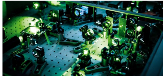
Mit Femtosekunden-Laserpulsen erzeugt das Forscherteam in Lund, Schweden, sogenannte Hohe Harmonische. Diese benutzen sie, um Attosekunden-Laserpulse zu erzeugen, und beobachten damit atomare Vorgänge.
