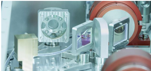
Optikaufbau für Laserverstärker in der Wissenschaft. Bild: TRUMPF
