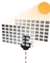
Die Ausbeute von Fotovoltaikmodulen verdoppelt sich außerhalb der Atmosphäre beinahe. Solarzellen im Orbit könnten einen Laserstrahl erzeugen und ihn auf Solarfarmen auf der Erde richten. Trotz der Wandlungsverluste und obwohl auch das Laserlicht die Atmosphäre kreuzen muss, sollte das ein solides Plus gegenüber rein terrestrischen Fotovoltaikfarmen gleicher Fläche ergeben.
