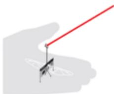
Mikrodrohnen brauchen winzige Komponenten — inzwischen kein Problem für Mechanik, Elektronik, Kameras oder Sensoren. Batterien jedoch sind an chemische Gesetze gebunden und sperren sich gegen die Miniaturisierung. Sie reichen nur wenige Minuten. Eine vielversprechende Idee ist es deshalb, die Mikrodrohne per Laserstrahl im Flug von der Hand in den Mund zu füttern.
