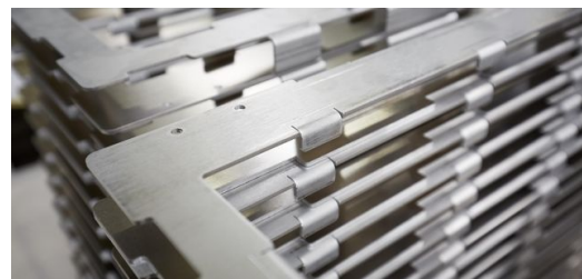
Frontteil eines Parkscheinautomaten aus Aluminium und Edelstahl. (Foto: Claus Langer)
