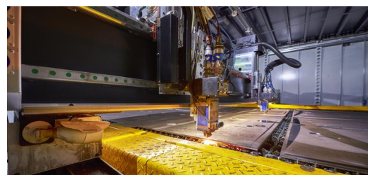
Zwei Schneidköpfe jeweils mit 0,5- und 1-mm-Faser können parallel oder
