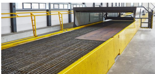
66 Meter ist der Tisch lang. Das reicht nicht nur für die größten Bleche,
