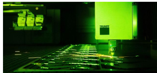
Prozesssicherheit ist für Hans Sanders das A und O. Daher ist er vom Sicherheitskonzept der TruLaser Center 7030 besonders begeistert. Das in die Bürstentische integrierte SmartGate, verhindert beispielsweise, dass Teile während des Schneidprozesses kippen.
