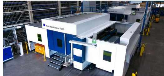
Automatisierung und Digitalisierung sind bei VDL die Schlüssel zum Erfolg. Die derzeit drei installierten Laser-Vollautomaten TruLaser 7030 von TRUMPF passen da perfekt ins Konzept. Sie erledigen alle Prozesse rund ums Laserschneiden vollautomatisch.
