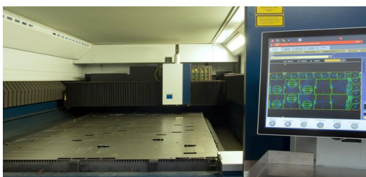
Smart Collision Prevention bietet ein Höchstmaß an Sicherheit – vor allem beim Schneiden von Blechen von unter fünf Millimeter Dicke. (Pototo Diez)
