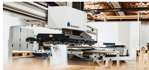
Automatisierung: Der SheetMaster versorgt die TruPunch 5000 mit dem benötigten Material. Das steigert die Effizienz und entlastet Mitarbeiter.
