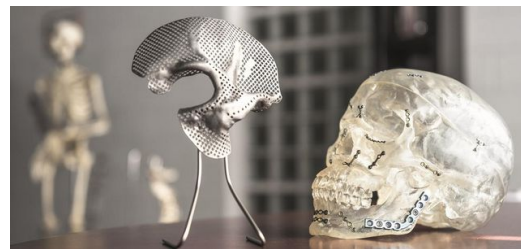
Was das Auge nicht sieht: Die im 3D-Druck herstellbaren Oberflächen sind entscheidend dafür, dass Implantate und Knochen zusammenfinden.
